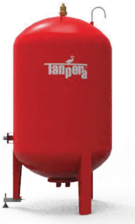
Снаружи расширительный бак окрашен промышленной краской, чтобы выдерживать условия в очагах тепла. Внутренняя часть бака окрашена антикоррозионной краской для повышения коррозионной стойкости. В мембране водопроводная вода. Снаружи мембрана открыта для атмосферы и не подвергается давлению.
