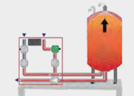
Когда температура воды в системе выходит на режим, давление в системе поддерживается постоянным благодаря регулированию давления насосной системы расширения/наддува до достижения максимальной нагрузки.
